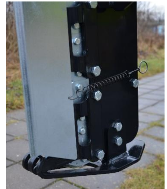
Figur 4 – Protection guard - 2 stk. kroge holder afskærmningen.
