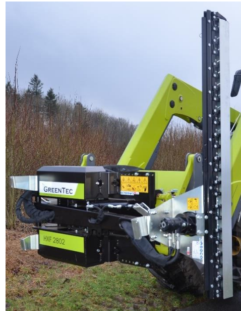
Figur 6 - Transport stilling med HXF-redskabsramme
